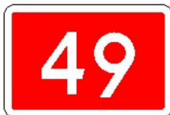
Rys. 6b. Znak E-15a z numerem dwucyfrowym
